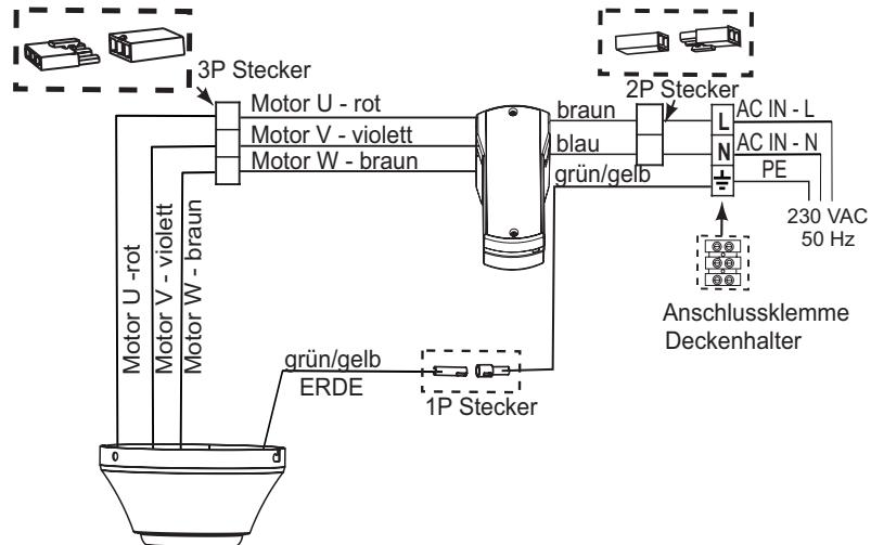
Verbinden Sie die Stecker wie in der Abbildung gezeigt und schließen Sie die Netzspannung an der Anschlussklemme an.
