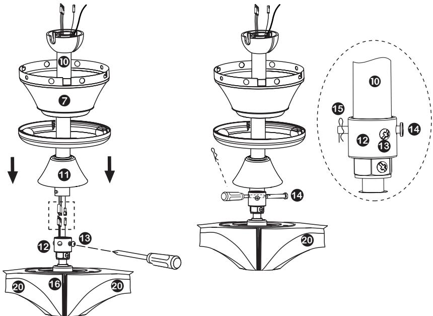
**DE** Verbinden Sie die Kabel des Motors mit den Kabeln der Deckenstange. Lösen Sie die beiden Schrauben an der Deckenstangenaufnahme am Motor und führen sie die Deckenstange ein. Stecken Sie den Sicherungsstift durch die vorgesehene Öffnung und sichern Sie diese mit dem Sicherungssplint. Ziehen Sie die beiden Schrauben an der Deckenstangenaufnahme wieder fest an.
