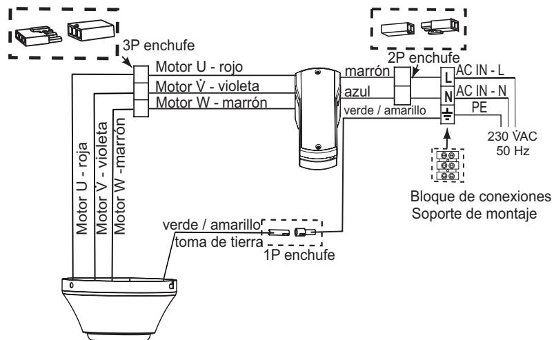
Conecte los enchufes como se muestra y conecte la tensión de la red al terminal.
