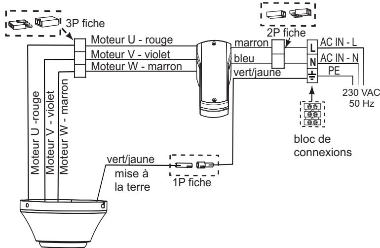
Branchez les fiches comme montré dans l'image et connecter la tension d'alimentation sur le bornier.
