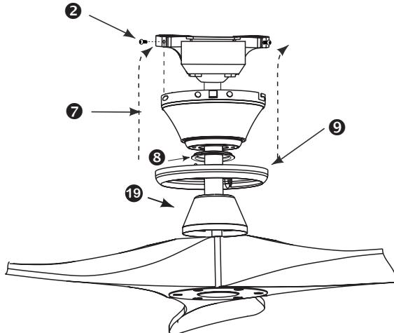
**DE** Schieben Sie den Baldachin nach oben auf den Deckenhalter. die beiden Schrauben müssen in die Bajonett-Öffnungen. Verdrehen Sie den Baldachin so, dass die Schrauben richtig sitzen. Ziehen Sie diese fest und schrauben Sie die beiden anderen Schrauben ein. Drücken Sie den Baldachin Ring und die untere Abdeckung nach oben, bis diese fest sitzen.
