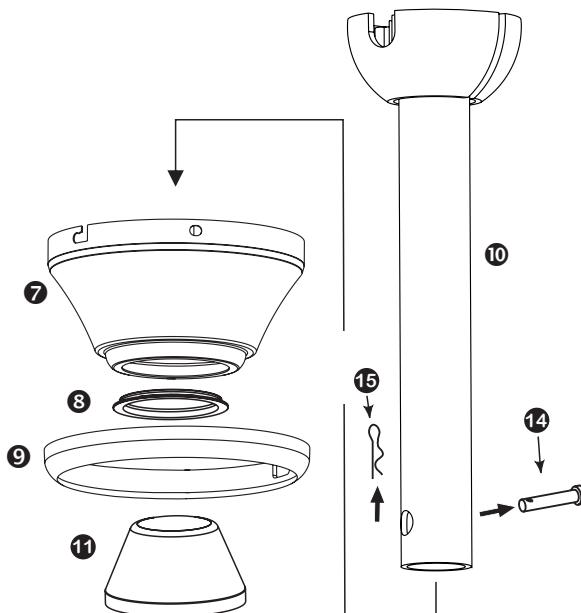
**DE** Entfernen Sie den Sicherungsstift und den Sicherungssplint aus der Deckenstange und legen Sie diese für die spätere Verwendung beiseite. Setzen Sie den Baldachin, den Baldachinring, die unter Baldachinabdeckung und die Abdeckung der Aufnahme der Deckenstange wie gezeigt mit der Deckenstange zusammen.
