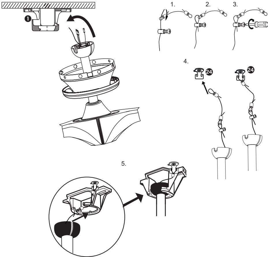
**[DE]** Hängen Sie den vormontierten Deckenventilator in den Deckenhalter. Verbinden Sie das Sicherheitsseil mit der Verschraubung zur Schlaufe und hängen Sie die Schlaufe in den Sicherheitshaken.
